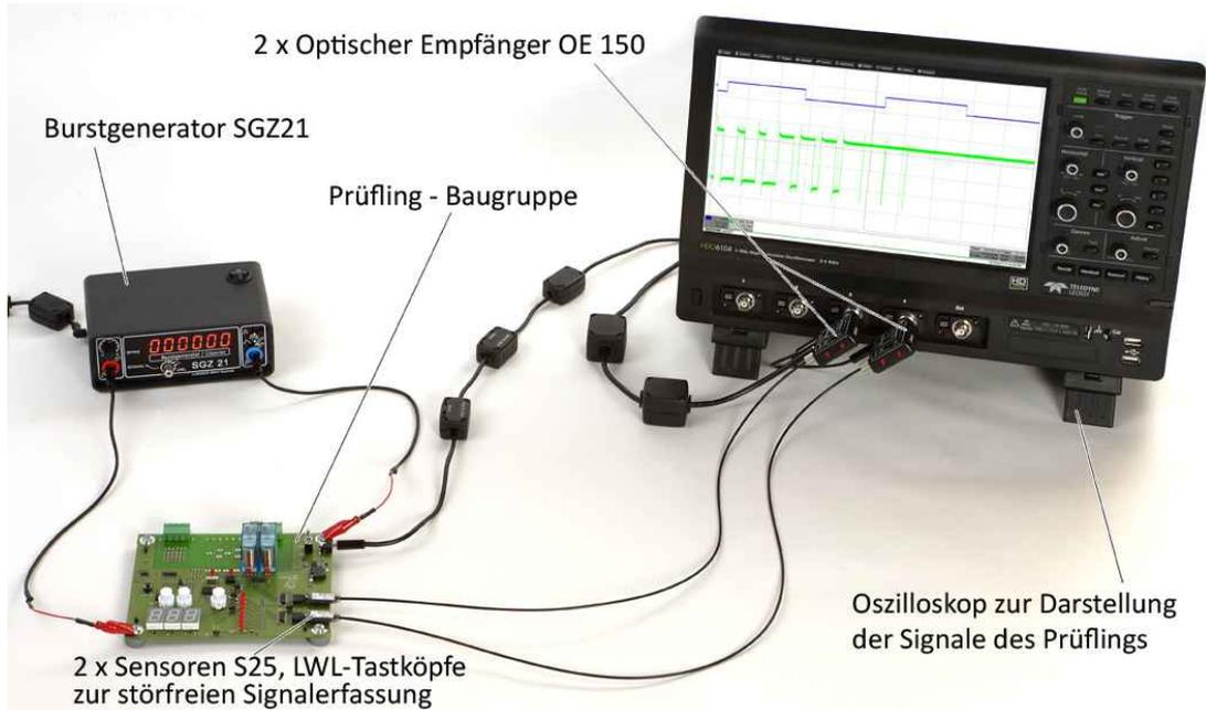
Anwendung mit optischem Sensor S25 im Detail
