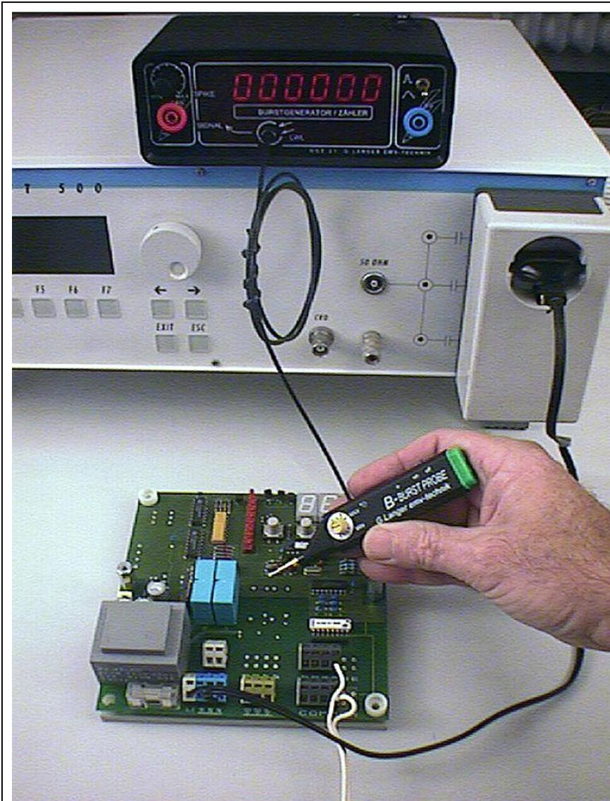
**Bild 2** Schwellwertverfahren mit MSA 02, SGZ 21 und Burstgenerator nach EN 61000-4-4
